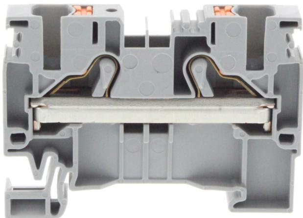
Durchgangsklemme, Push-in-Anschluss, Montageart: TS 35/7,5, Bemessungsquerschnitt: 6 mm<sup>2</sup>, Breite: 8,1 mm, Farbe: Grau
